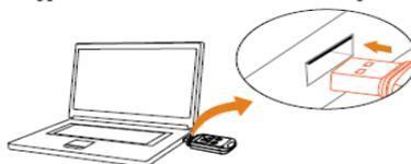
Αφαιρέστε το κάλυμμα της θύρας USB και συνδέστε το καταγραφικό στον Η/Υ σας. Το αρχείο PDF με τα καταγεγραμμένα δεδομένα θερμοκρασίας θα δημιουργηθεί αυτόματα και το καταγραφικό θα εμφανιστεί ως Αφαιρούμενη Μονάδα Δίσκου «Elitech LOG».
